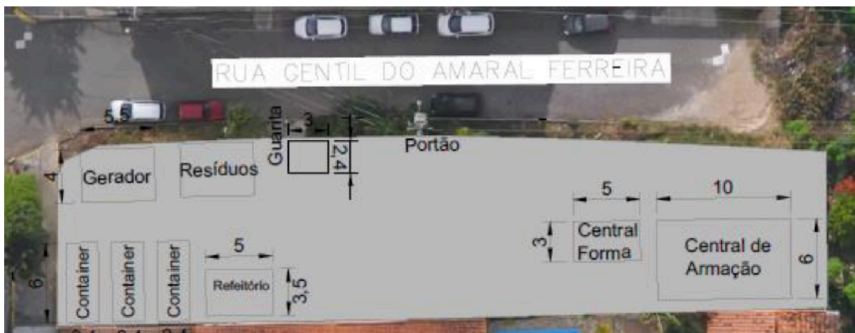
Figura 2.2.12-3: Layout do canteiro de obras – estoque ponte.
