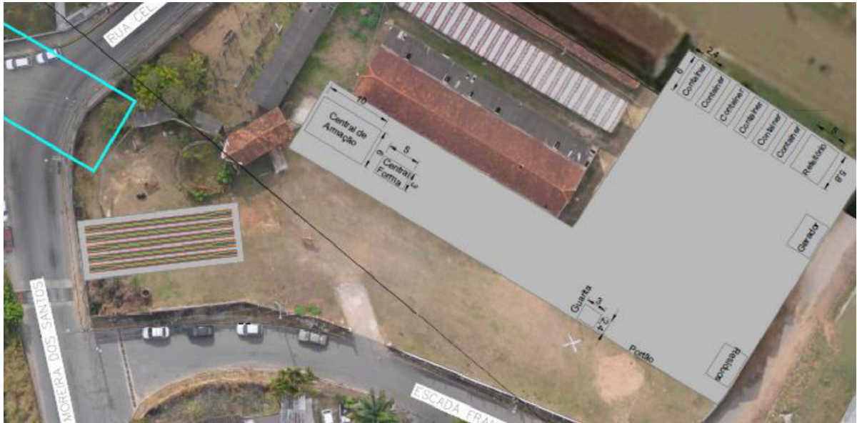
Figura 2.2.12-4: Layout do canteiro de obras – viaduto.
