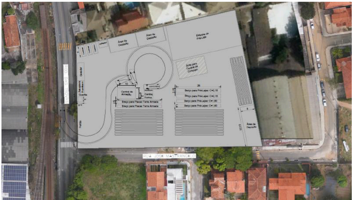
Figura 2.2.12-5: Layout do canteiro de obras – pré-moldados.
